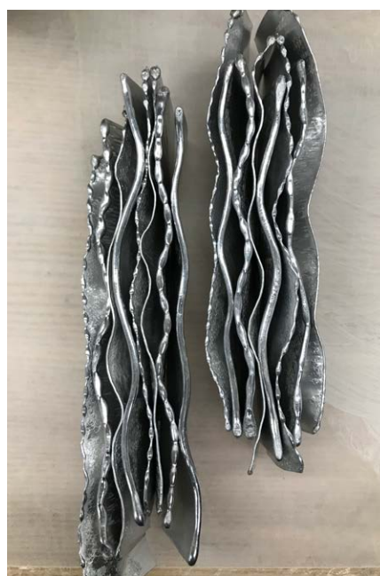
何枚も重ねて接合しひとつのパーツ が出来上がる
